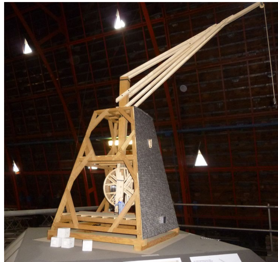
Fig. 16. Maqueta de la grúa medieval de la catedral de Colonia. Accionada mediante tambor, contaba con un eje vertical que giraba sobre sí mismo. Fuente: http://www.floerken.de/koeln/dom/koelner_dom.htm
